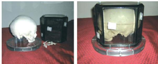
Fig. A-1. Fantoccio costituito da contenitore e base circolare in plexiglas con all'interno teschio in plastica che si estende dalla base cranica al vertice. Nel contenitore esterno sono applicati marker radiopachi visibili solo nelle acquisizioni TC
