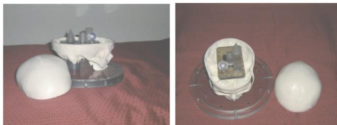
Fig. A-2. La calotta del teschio è separabile dalla base cranica la quale invece è solidale alla base di appoggio circolare. All'interno del teschio si trova una struttura in plexiglas costituita da una base su cui giacciono un parallelepipedo, un cono ed una sfera con bacchetta di aggancio alla base. Le strutture geometriche sono in plexiglas.
