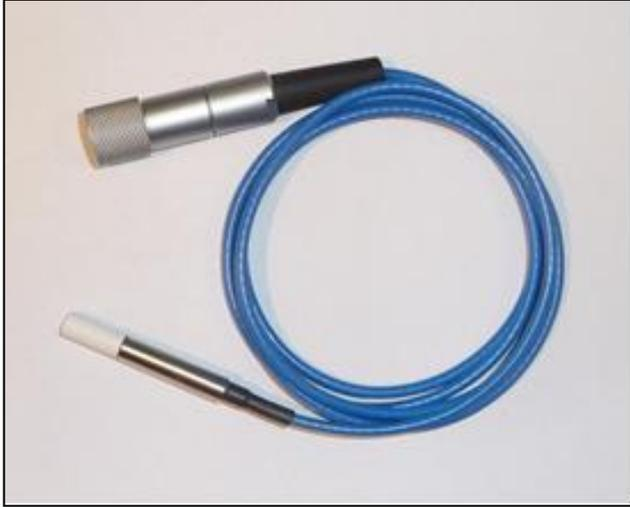
**Il dosimetro:** diodo Schottky a base di diamante sintetico monocristallino realizzato presso i laboratori dell'Università Tor Vergata di Roma (nella foto con incapsulamento PTW)
