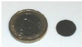
Fig. 1: Il rivelatore ad attivazione di disprosio.
