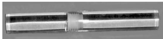
Figura 5 - Fantoccio utilizzato per la determinazione dello SSP
