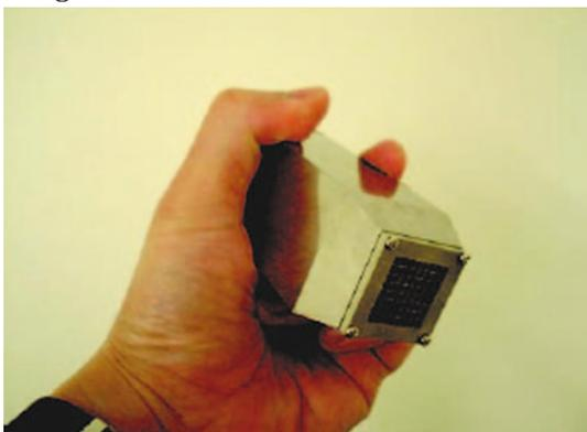
Fig. 5: Sonda intra-operatoria per chirurgia radioguidata (Yamamoto e coll.)
