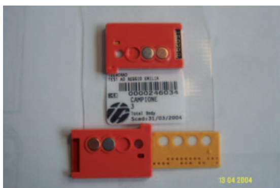
Figura 4. Nelle foto sono riportati i dosimetri a termoluminescenza utilizzati e i dosimetri a lettura diretta MGP DMC 2000 X.
