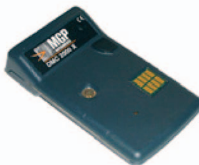
Figura 4. Nelle foto sono riportati i dosimetri a termoluminescenza utilizzati e i dosimetri a lettura diretta MGP DMC 2000 X.
