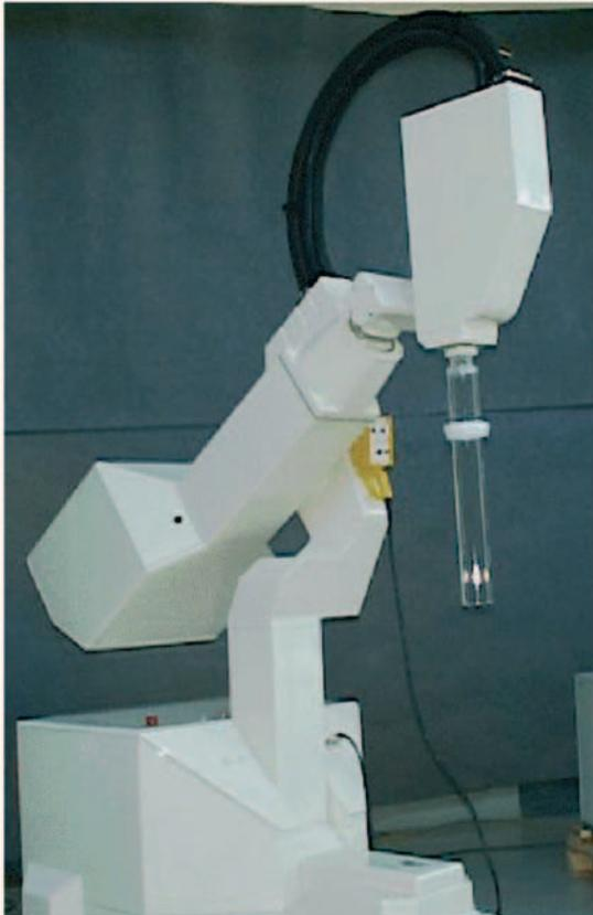
Figura 10. L'acceleratore lineare Novac 7 per IORT sul quale sono state eseguite le prime misure.
