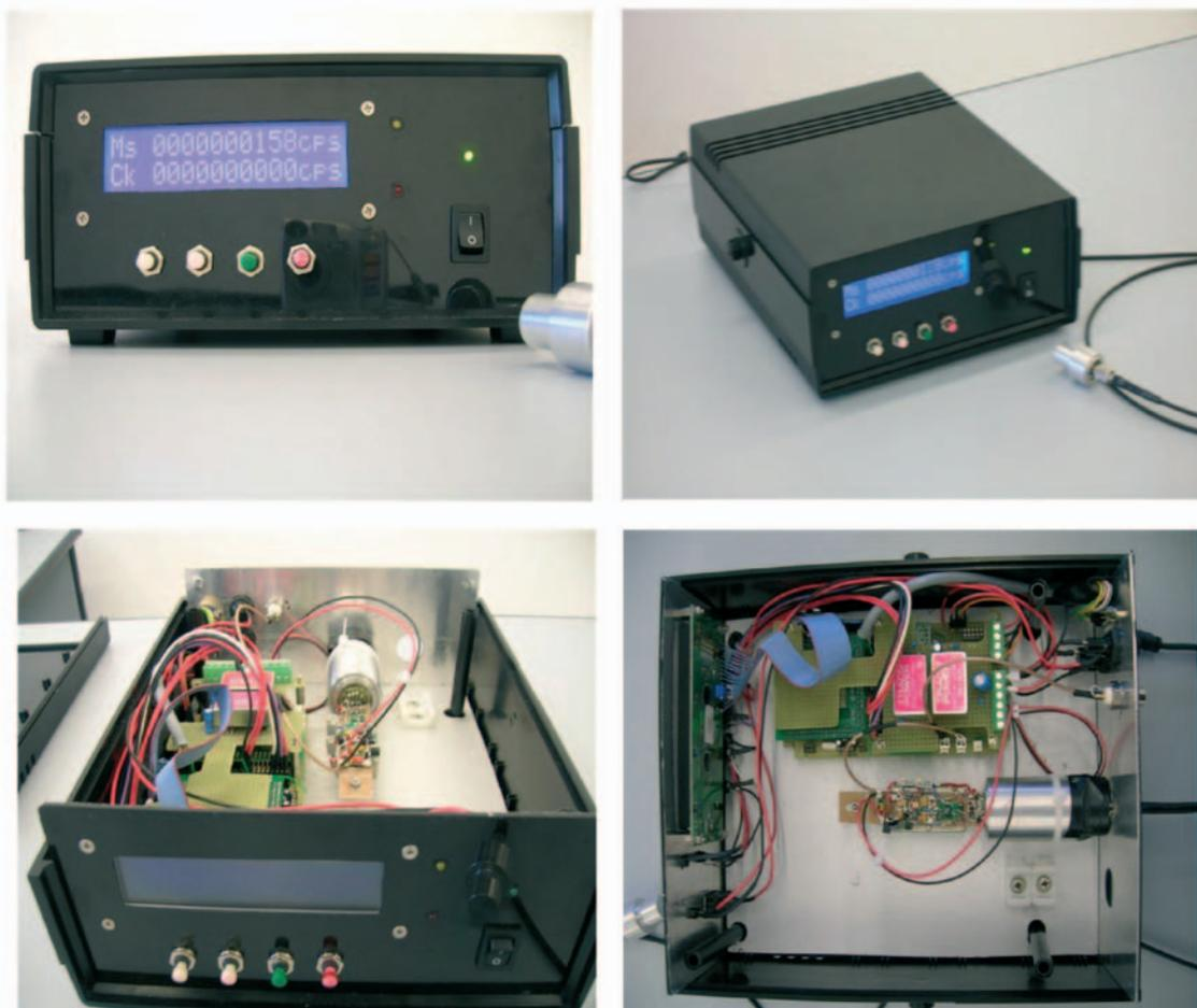
Figura 7. Il prototipo del nuovo dosimetro: un fotomoltiplicatore (o un diodo) raccoglie la luce prodotta dalla radiazione nel vetro radioluminescente e trasportata dalla fibra ottica e la trasforma in un segnale elettrico.
