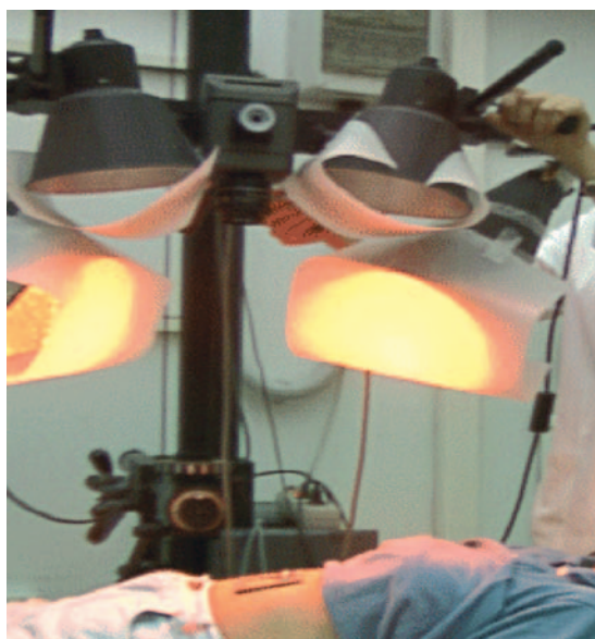
Figura 2: L'evoluzione strumentale nel corso degli anni. Il telespettrofotometro (seconda generazione)
