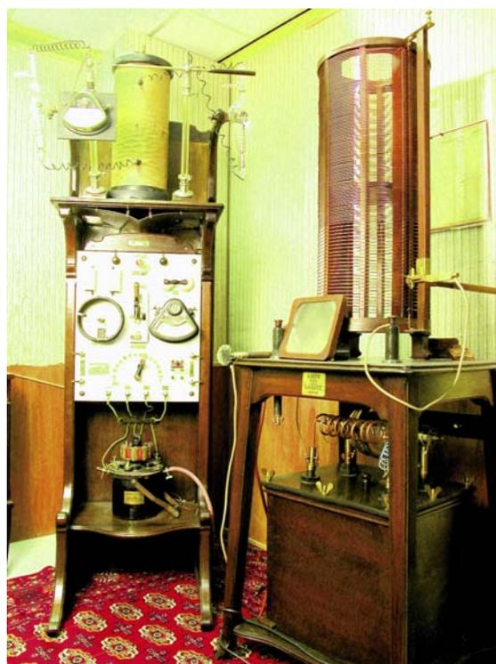
Sulla sommità della consolle dell'apparecchio di fig.5 ai lati della grossa bobina (anch'essa utilizzata per l'alta tensione) sono presenti due bulbi in vetro: si tratta di valvole raddrizzatrici a gas di tipo Villard. Sebbene il diodo ad effetto termoionico, con le sue proprietà raddrizzatrici, fosse già noto (fu brevettato da J. A. Fleming nel 1904), prima che fossero introdotti i tubi di potenza a cato-
