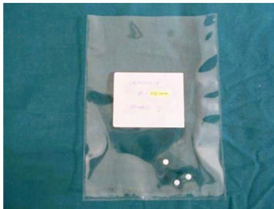
**Figura 1** – Dosimetri TL LiF(Mg,Cu,P) GR-200-A.
