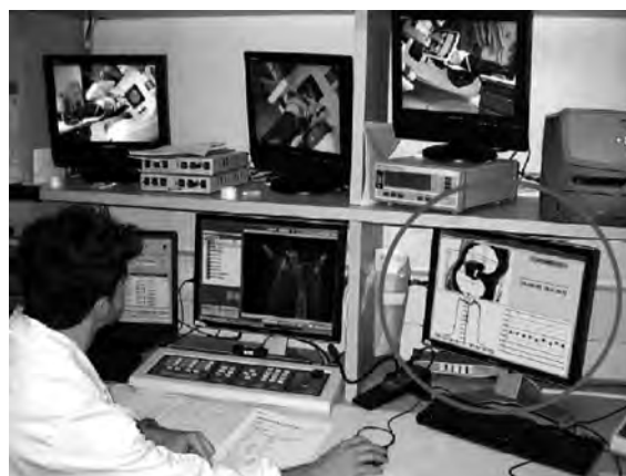
Figura 1 Sala comandi di un linac in cui è operativo il software DISO. Il risultato del test è messo in evidenza sul video indicato con un cerchio.
