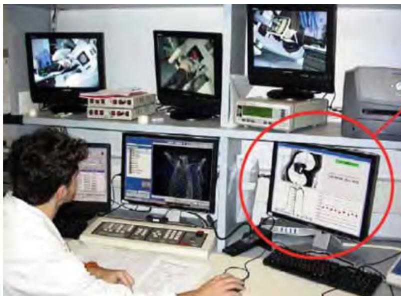
In Figura 1 è riportata la sala comandi di un linac in cui è operativo il software DISO gestito dal Tecnico di Radiologia Medica. Il risultato del test di dosimetria in-vivo per tutti i fasci è disponibile dopo 1 o 2 minuti dal termine della frazione di trattamento.
