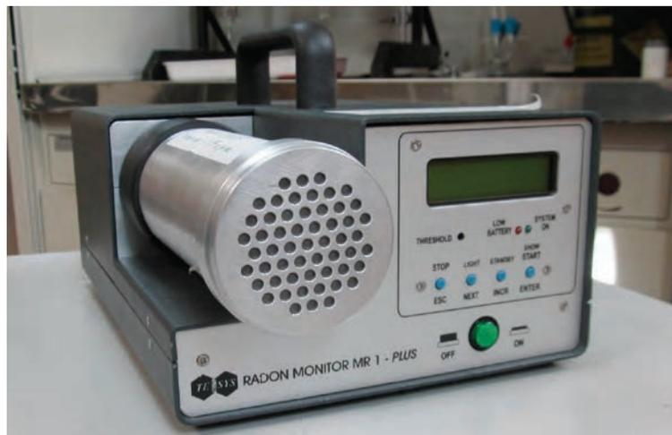
Figura 3: Monitor di radon basato su cella a scintillazione.
