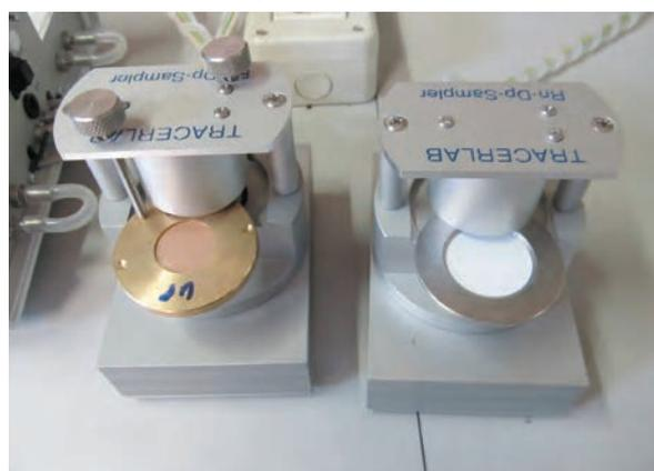
Figura 8: I due campionatori dello strumento di misura dei prodotti di decadimento del radon e del toron.
